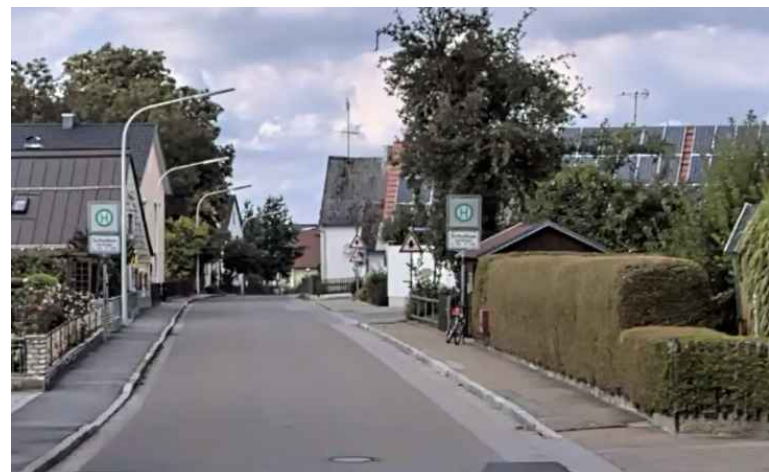
KEIN GESICHERTER ÜBERGANG, ABSenkUNGEN NICHT BARRIEREFREI UND FÜR EINE ÜBERQUERUNG NICHT GEGENÜBER LIEGEND (HOFMARK) (-)
